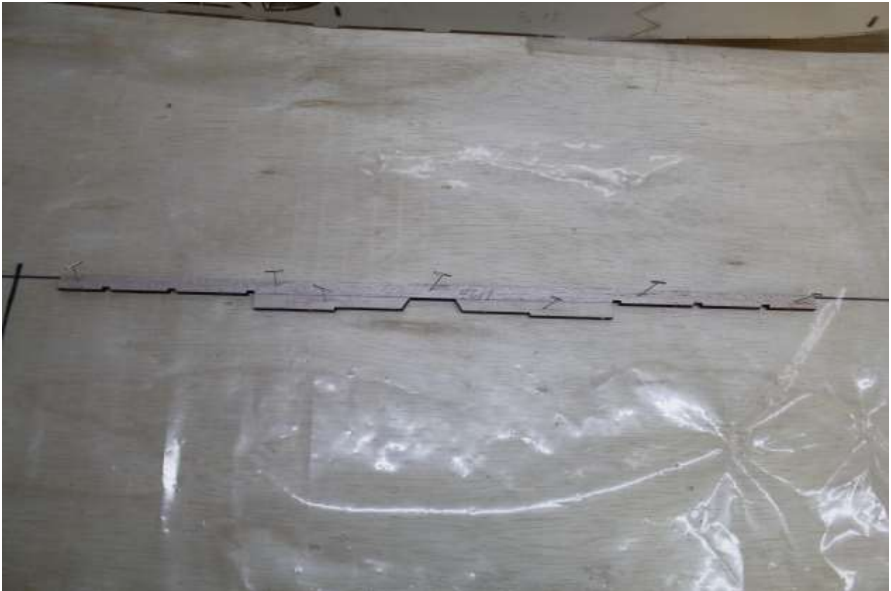
Frontleiste der Ruderklappe (H20) auf Bauunterlage heften. Verstärkungen (2xK17) verleimen.
