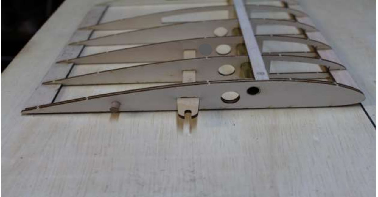
Deckrippe (D1) mit Dübel und Halter für Tragflächensicherung (M6) verleimen.
