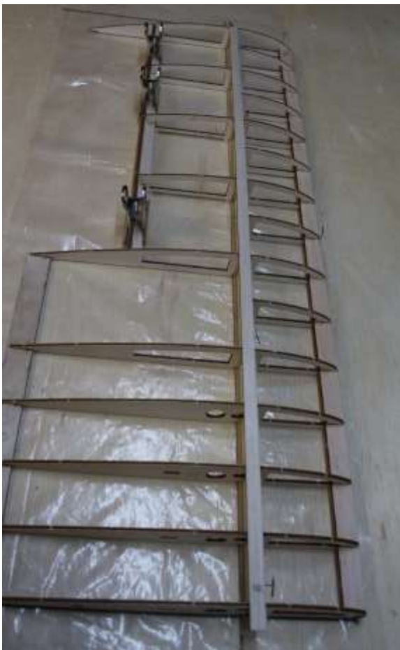
Oberer Hauptholm (G2) mit Bindan Holzleim einleimen.
