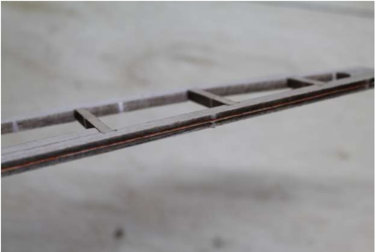
Scharnierlinie an Dämpfungfläche und Ruderklappe anzeichnen.
