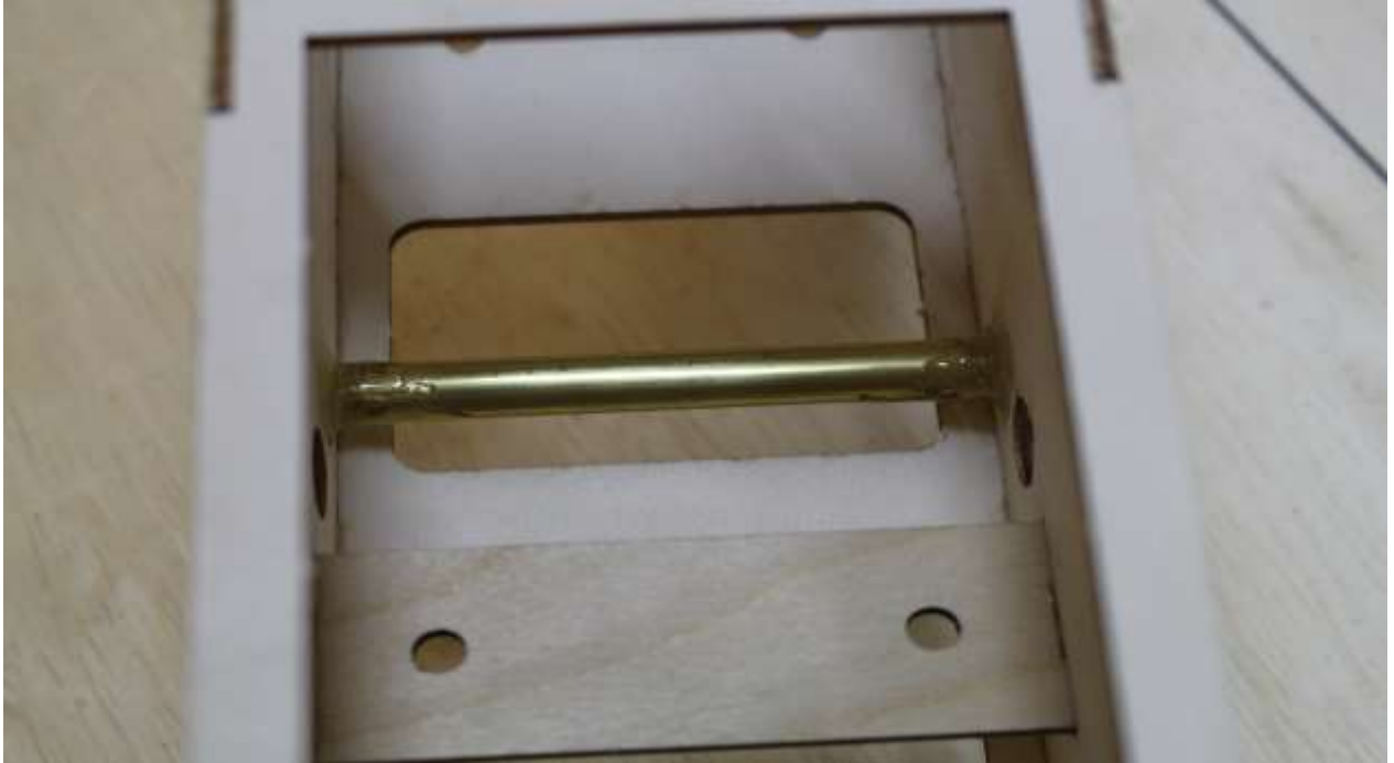
Führungsrohr (Messing \text{\O}9 \times 90 \text{ mm} ) in Rumpfseitenteile mit Epoxy einkleben.
