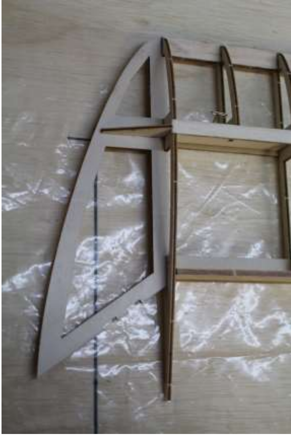
Randbogen (C8) an Rippe (D6) verkleben.
