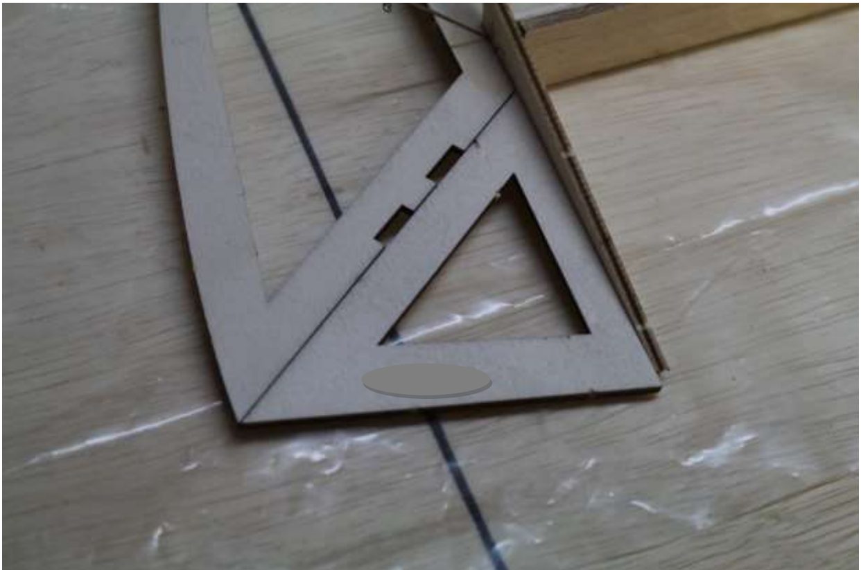
Hinteres Teil des Randbogens (C9) verleimen. Dabei beachten, dass dieses leicht schräg zum Rippenende hin verläuft.
