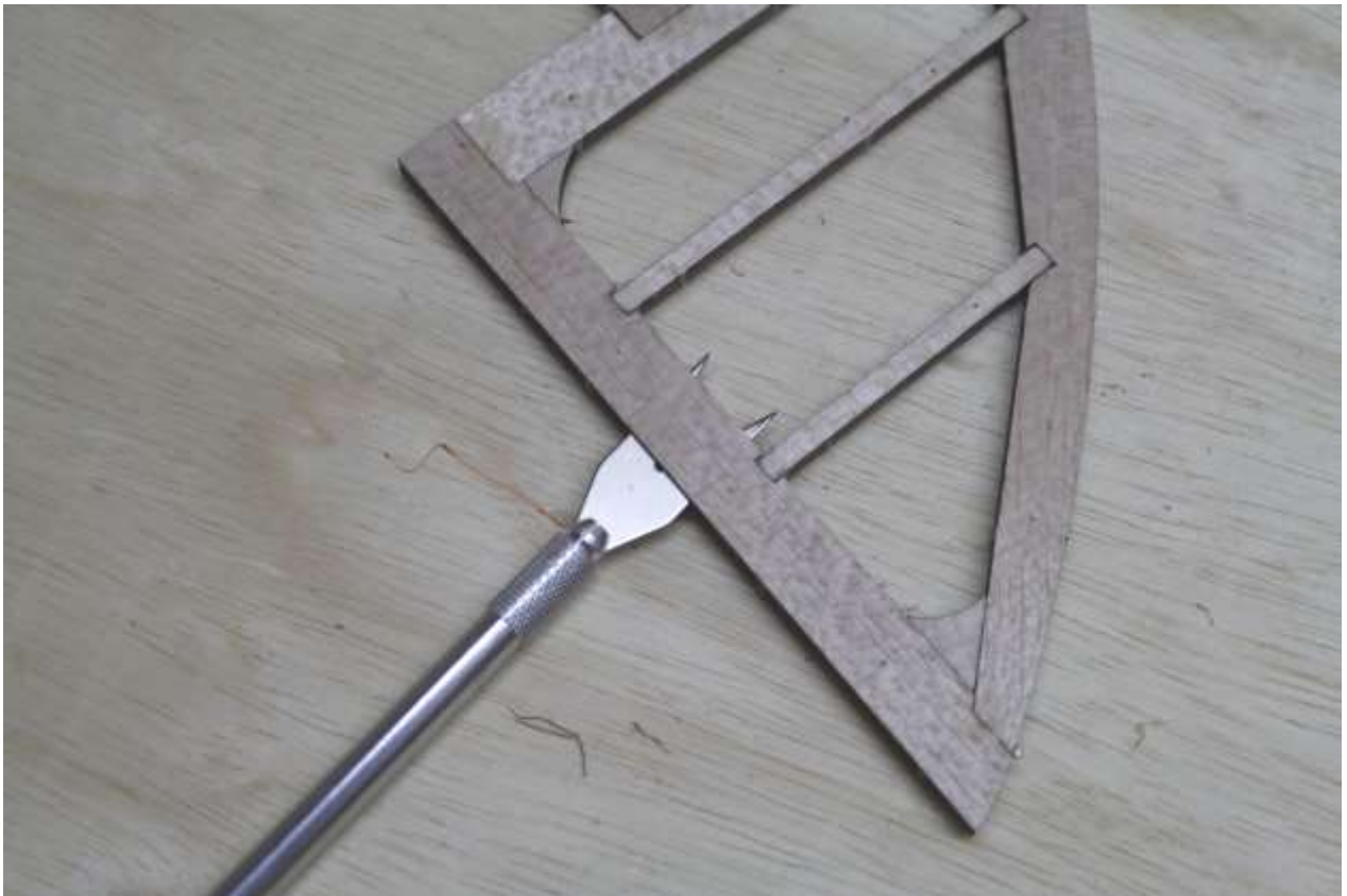
Schlitze für Scharniere mit Scharniermesser anbringen.
