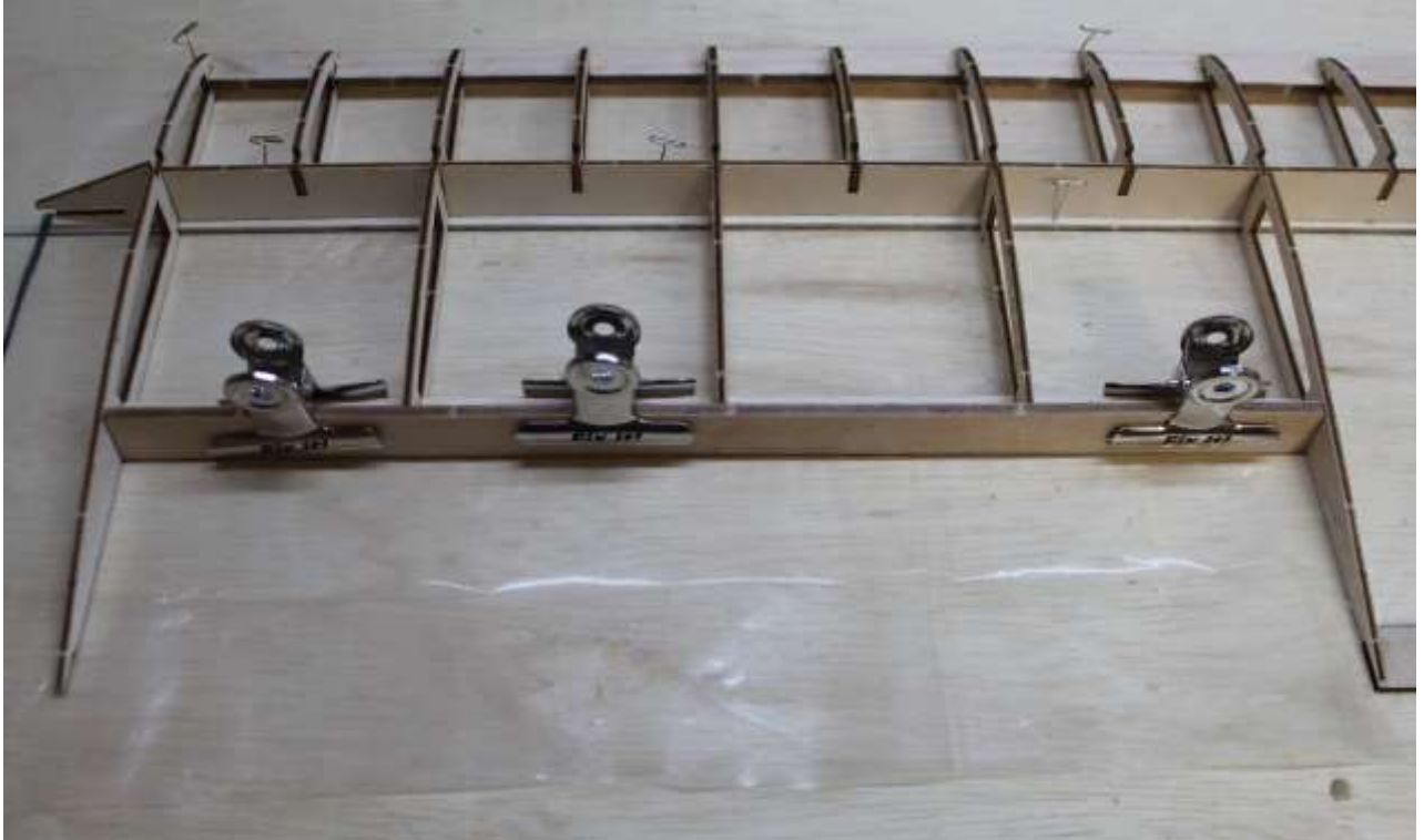
Abschlussleiste (i1) Balsa 5 mm Hochkant im Querruderausschnitt mit Bindan Holzleim verleimen.
