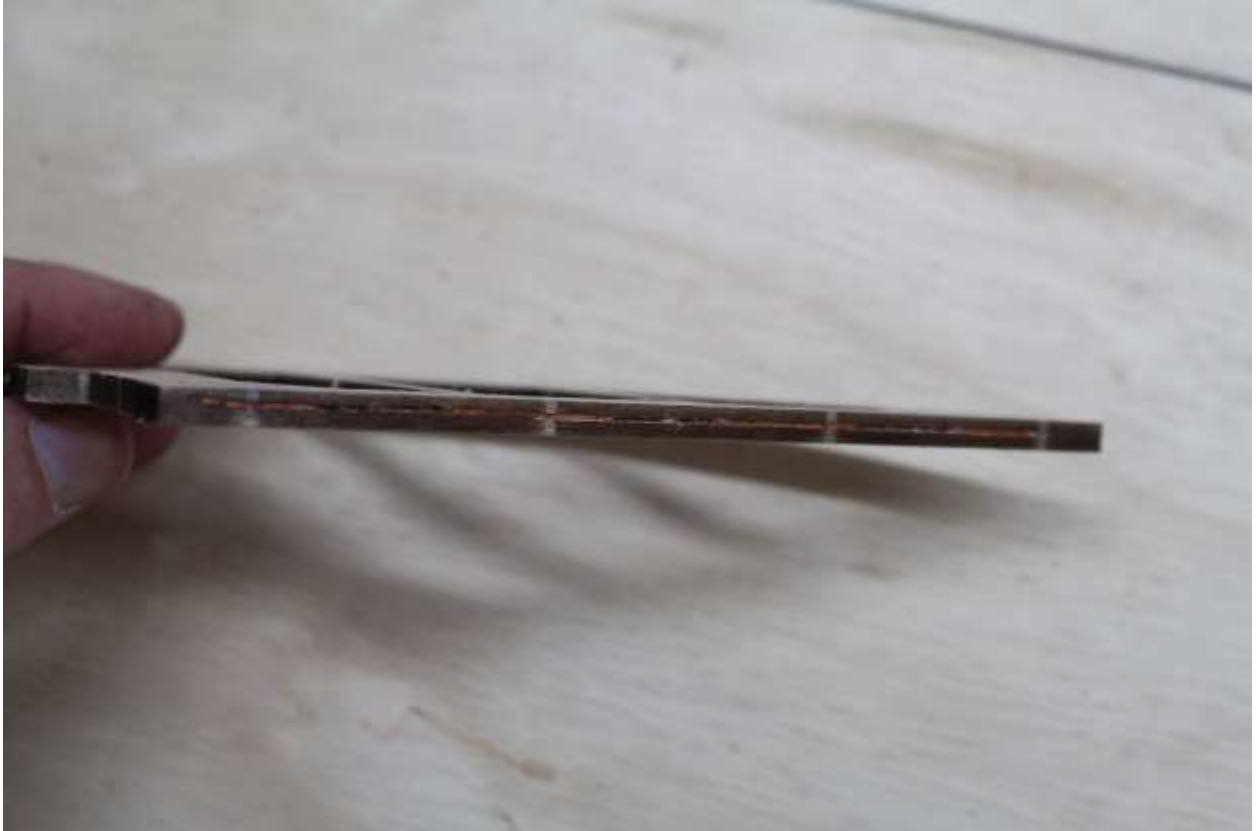
Scharnierlinie an Dämpfungsfläche und Ruderklappe anzeichnen.
